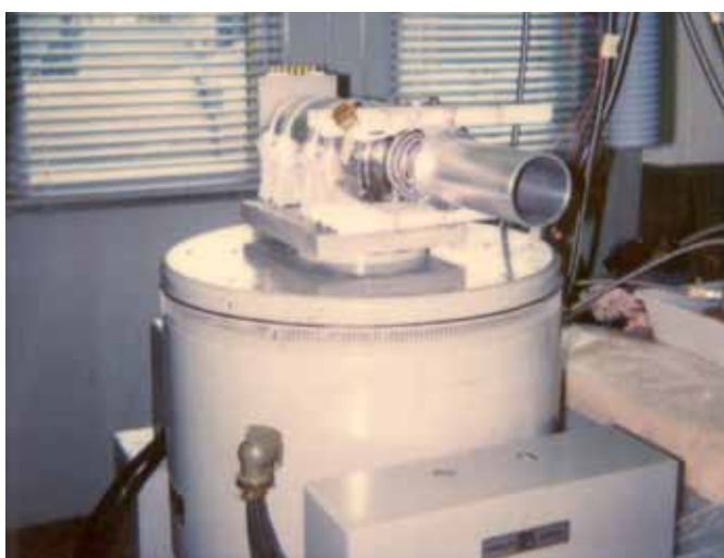
Il dimostratore tecnologico della BMU sulla tavola vibrante del Laboratorio Prove Dinamiche della DTM (foto dell'autore, 15 marzo 1989)
